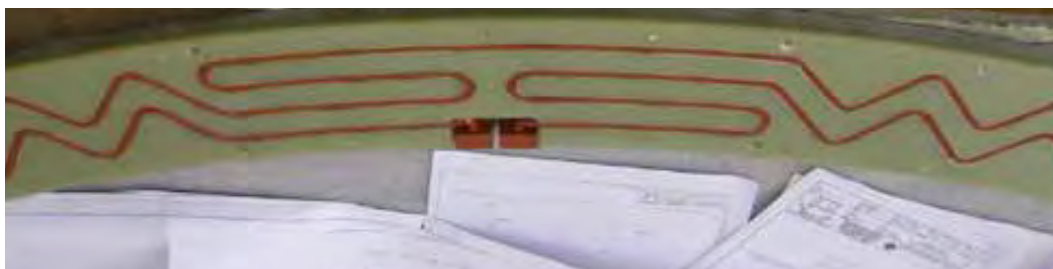
Induttore montato sotto un nastro trasportatore per il riscaldamento di lattine metalliche.
