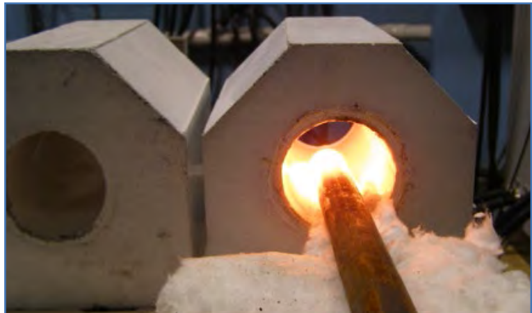
Riscaldamento a 1100°C di tonde diametro 75mm per la ricalcatura della testa. Viene usato un induttore con 8 stazioni di riscaldamento per fornire al robot di carico pressa un ritmo di una barra ogni 20 secondi.
