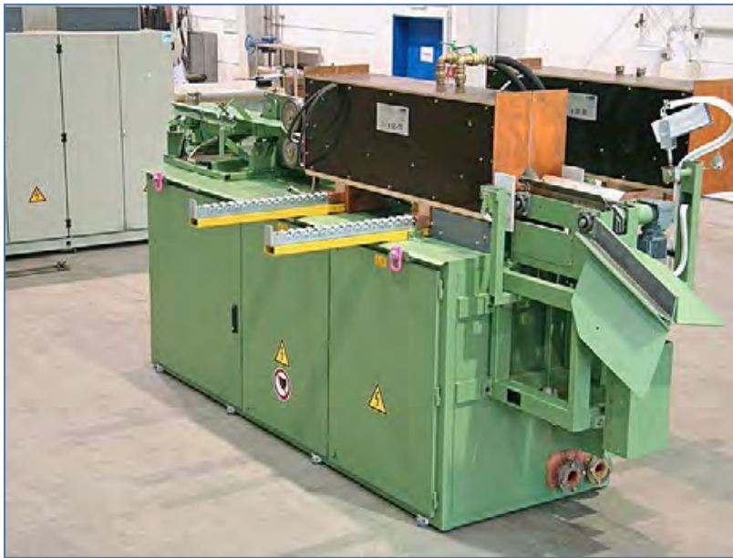
Riscaldatore per billette di acciaio diametro 48mm lunghezza 350mm. La produzione prevede il riscaldamento di una billetta ogni 12 secondi. Ambrell ha collaborato con un'azienda OEM per fornire al cliente la soluzione chiavi in mano.
