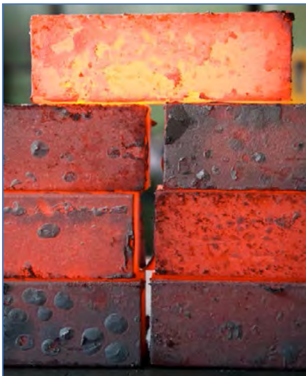
Riscaldatore per billette di acciaio diametro 48mm lunghezza 350mm. La produzione prevede il riscaldamento di una billetta ogni 12 secondi. Ambrell ha collaborato con un'azienda OEM per fornire al cliente la soluzione chiavi in mano.
