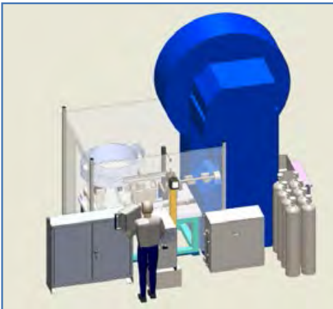
Cellula di lavoro automatica per lo stampaggio di bulloni. Ambrell ha collaborato con una azienda OEM per fornire una soluzione chiavi in mano. (disegno fornito da Nutek)
