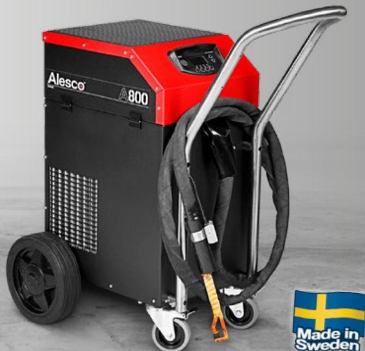
ALESCO A800 è un riscaldatore a induzione da 10 kW costruito per l'utilizzo quotidiano nelle officine meccaniche. Viene fornito completo di induttore standard e di un sistema di raffreddamento integrato con serbatoio da 25 litri pieno di miscela acqua-glicole; altri induttori e cavi flessibili di varia lunghezza sono invece disponibili come accessori.
