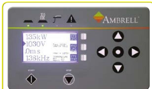
EkoHeat è dotato di display con tastiera programmabile sul pannello anteriore per il monitoraggio, la regolazione del timer e della potenza, le informazioni di diagnostica e la configurazione di sistema. Possono essere preimpostati fino a 10 profili di riscaldamento ognuno avente 10 diverse fasi di regolazione della potenza per realizzare cicli di riscaldamento specifici e ripetibili.
